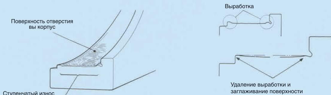
Рис. 8.5 Коррекция ступенчатого износа на поверхности отверстия корпуса.
