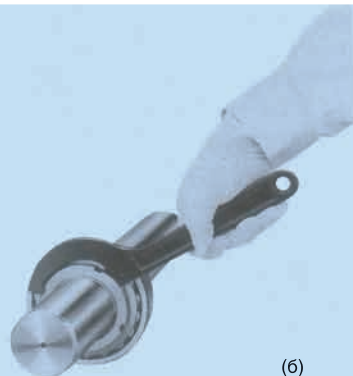
Рис. 2.6 Способ затяжки стопорной гайки
